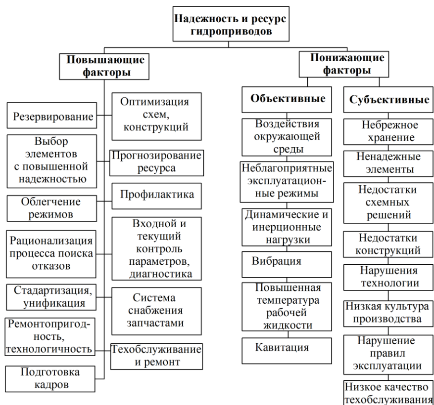
Рисунок 3 – Факторы, влияющие на надежность гидросистем строительных машин
